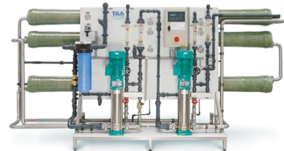
Doppelstufige Revers-Osmose Anlage, Leistung 5 m³/h
