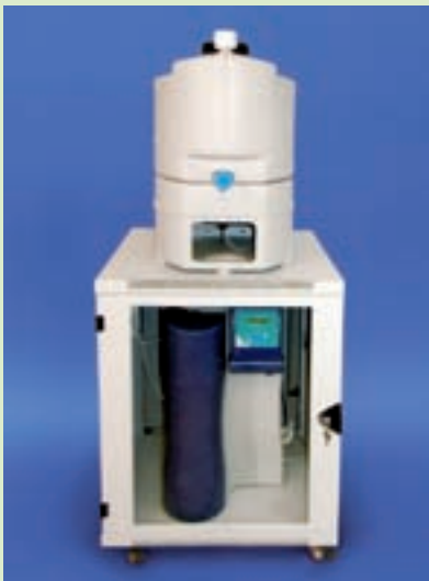
TKA Pacific AFT 3 – 40 im Schrank mit Tank 30 Liter Leistung bis 40 l/h.
